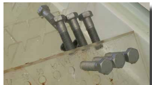
Badanie odporności korozyjnej w komorze solnej Corrosion resistance examination
