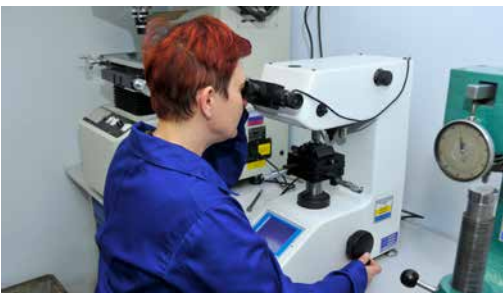
Pomiar twardości i kontrola wymiarów Hardness test and dimensional inspection
