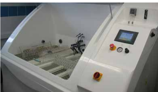
Badanie odporności korozyjnej w komorze solnej Corrosion resistance examination
